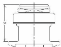
A - Altura (mm): 104,30 B - Diâmetro do furo (mm): 63,20 Peso (kg): 2,72
